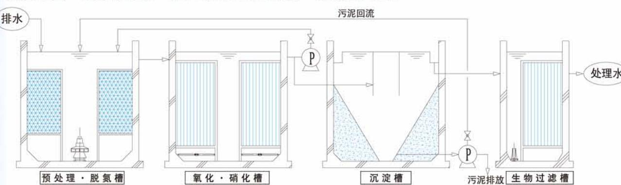
由于BF具有较长的生物固体停留时间，能够大量繁衍生存世代时间长的硝化菌，发挥十分罕见的硝化能力，提高污水处理能力，槽容最小，且免维护，以致于投资效益最大。
